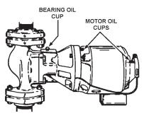
A TYPICAL CIRCULATING PUMP FIGURE 14.
