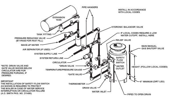
A TYPICAL BOILER INSTALLATION FIGURE 7.
