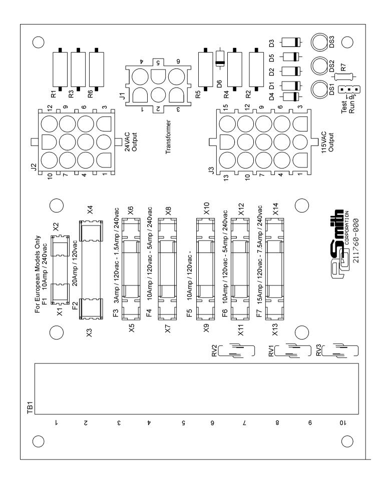
Figure 19. PDB POWER DISTRIBUTION BOARD Diagram
