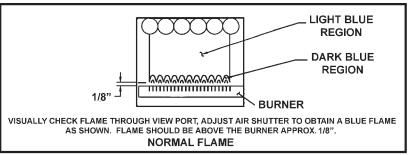
FIGURE 28. BURNER FLAME CHARACTERISTICS
