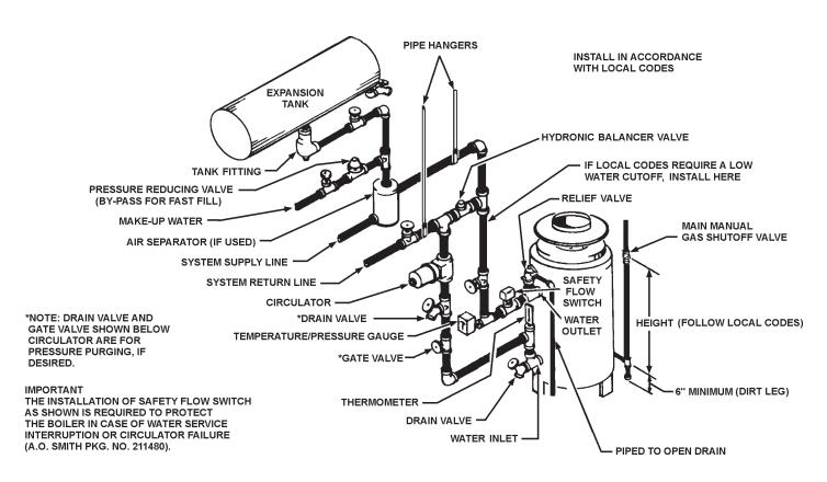
A TYPICAL BOILER INSTALLATION FIGURE 1
