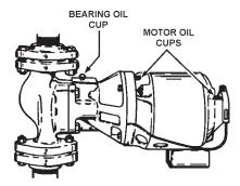
A TYPICAL CIRCULATING PUMP FIGURE 5
