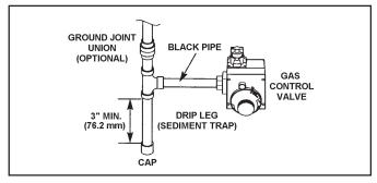
FIGURE 14. GAS PIPING WITH ALL BLACK IRON PIPE TO GAS CONTROL.
