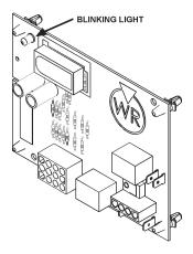
FIGURE 4-IGNITION CONTROL BOARD
