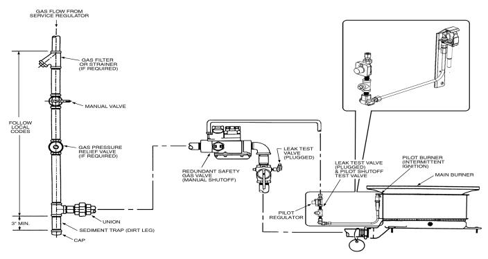
FIGURE 1. CSD-1 GAS CONTROL DIAGRAM
